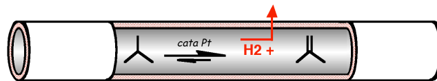
Figure 6 : Un exemple de CMR extracteur appliqué à la déshydrogénation de l'isobutane dans une membrane de forme tubulaire.
